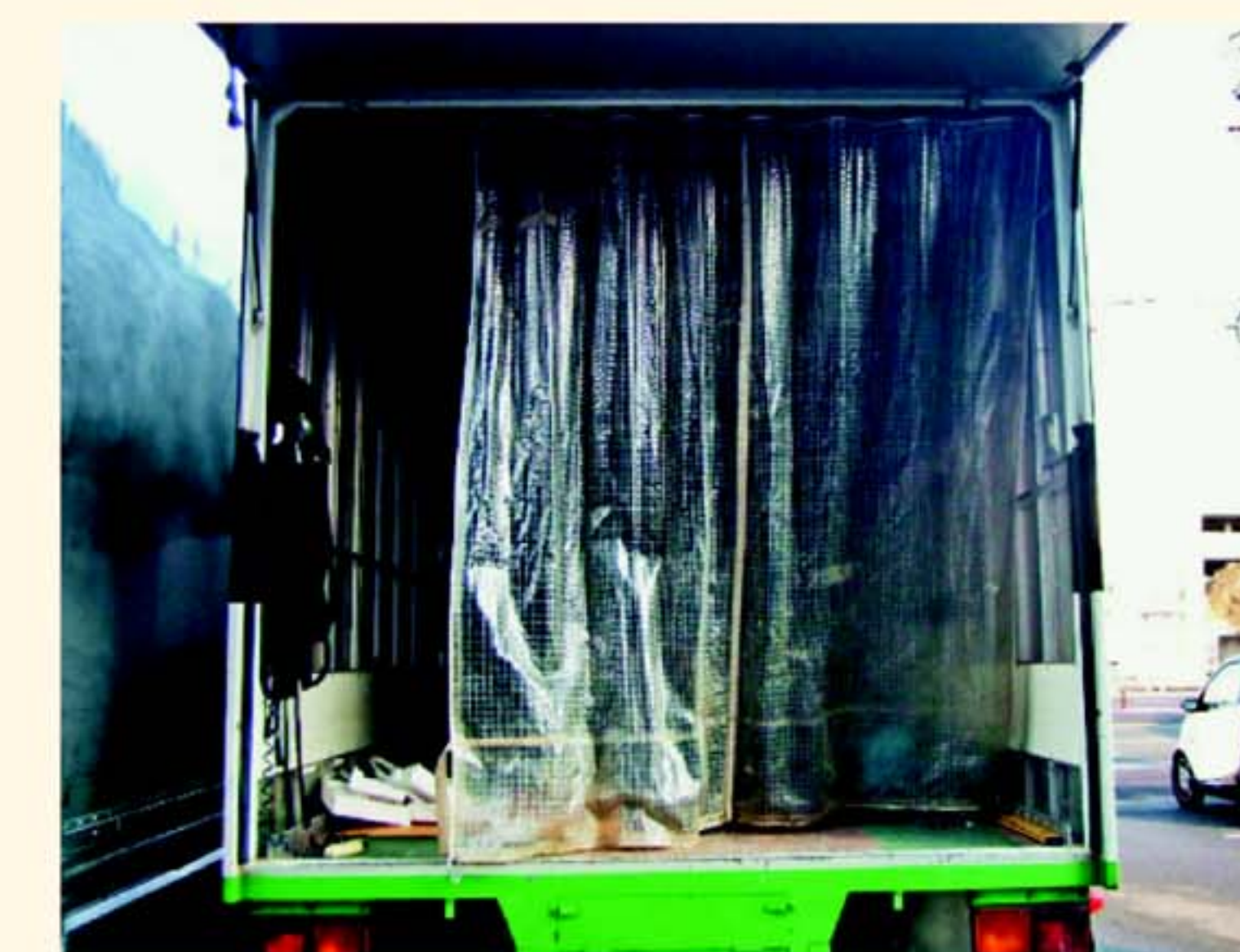
■ トラック D30レールにビニールシート
