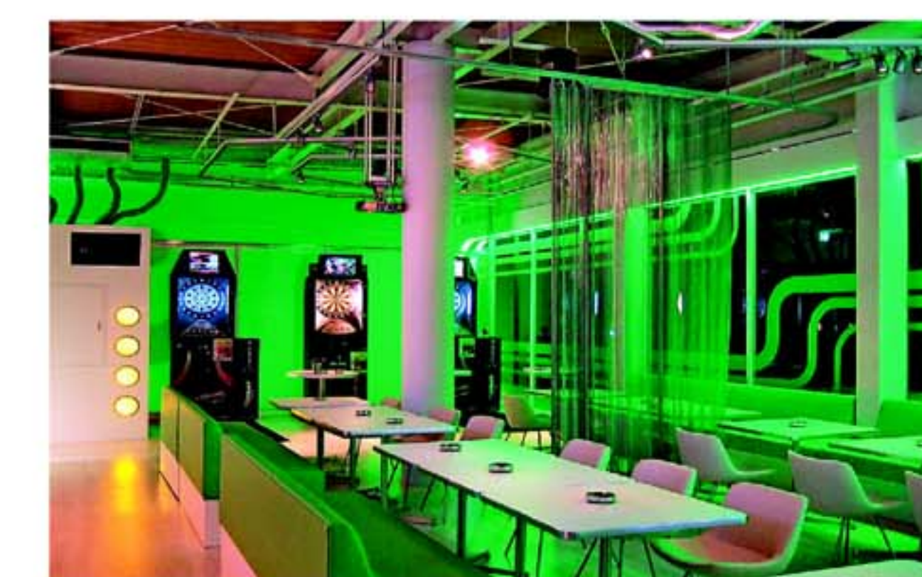
■ 飲食店間仕切 吊棒とD30レールにチェーンカーテン
